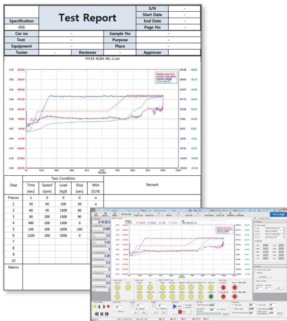
**Seizure Tester(Model STW240)**는 자동차 에어컨 컴프레서 용 사판 코팅에 대한 특성 평가와 사판 소재에 따른 코팅의 부착력 및 내마모성, 내시저성 등을 평가하기 위한 시험기이다. 사판 자체에 대한 데미지 뿐만 아니라 에어컨 컴프레서 작동과 유사한 환경 조건을 가지고 극한 상황에 대한 시뮬레이션이 가능하도록 제작되었으며, 이러한 조건에서 소재의 마모 및 마찰특성을 평가할 수 있도록 건식 또는 습식 조건에 의한 마찰 마모 분위기를 조절하거나 다양한 조건으로 측정할 수 있도록 구성되었다.
