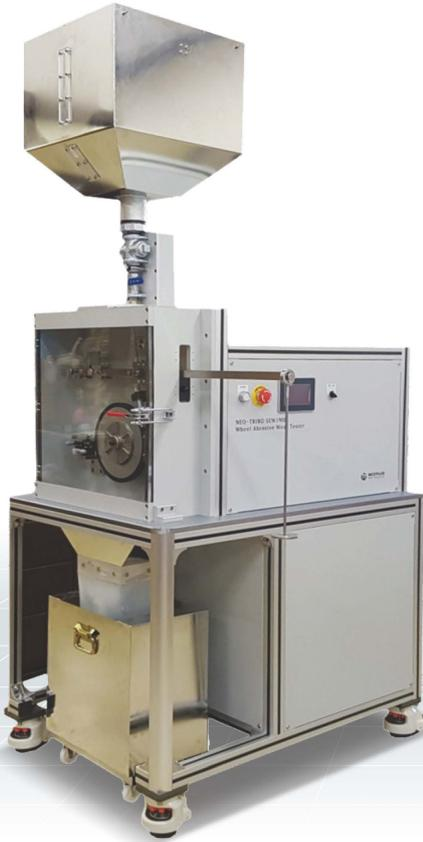
**Slurry Erosion 시험기 (Model SEW190D)**는 SiC, Al<sub>2</sub>O<sub>3</sub>, SiO<sub>2</sub> powder, sand 등으로 일정량을 시료표면에 투사하여 재료의 표면손상 등을 측정하기 위한 시험기로서 다양한 종류의 재료에 대해 Sand Erosion 현상을 측정할 수 있는 시험기이다.
