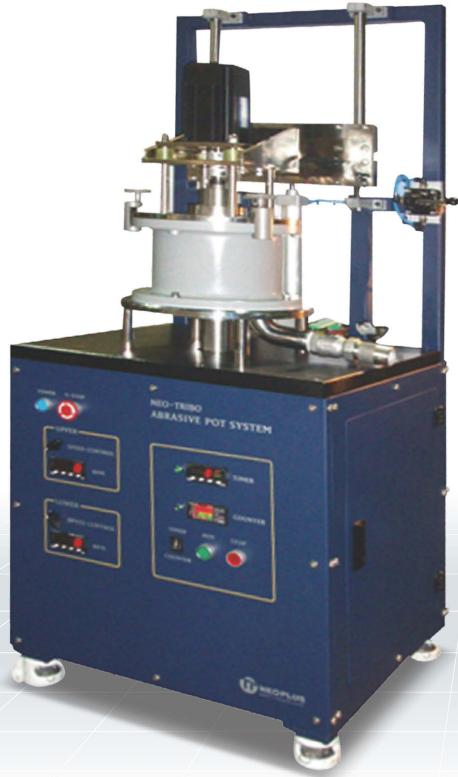
**Slurry Erosion 시험기(Model SEW190)**는 SiC, Al<sub>2</sub>O<sub>3</sub>, SiO<sub>2</sub> powder, sand 등으로 건식과 습식 또는 부식 분위기에서 재료의 표면손상 등을 측정하기 위한 시험기로서 다양한 종류의 재료에 대해 Slurry Erosion 현상을 측정할 수 있는 시험기이다.
