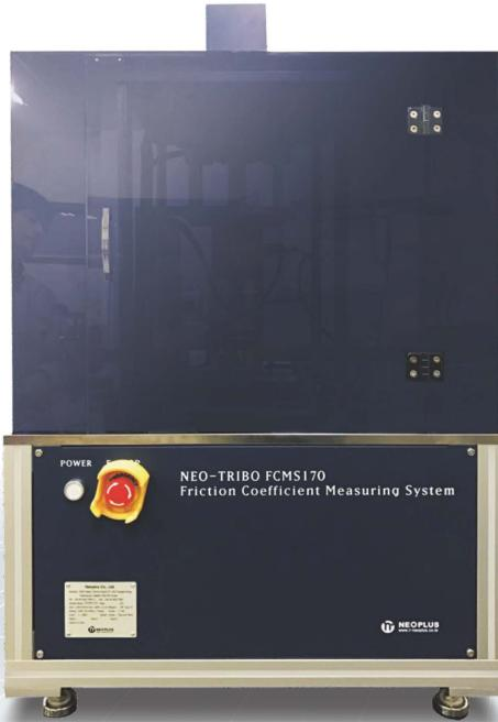
3방향 마찰계수 시험기(Model FCMS170-3D)는 X, Y 축을 이동하면서 다양한 마찰패턴의 마찰계수 측정이 가능한 장비이며, AC Servo Motor를 이용하여 Z 축 하중을 제어할 수 있다. 평가 가능한 재료는 금속, 세라믹, 요업재료, 플라스틱, 고무 등 다양한 소재에 대한 마찰계수 측정이 가능하다.
