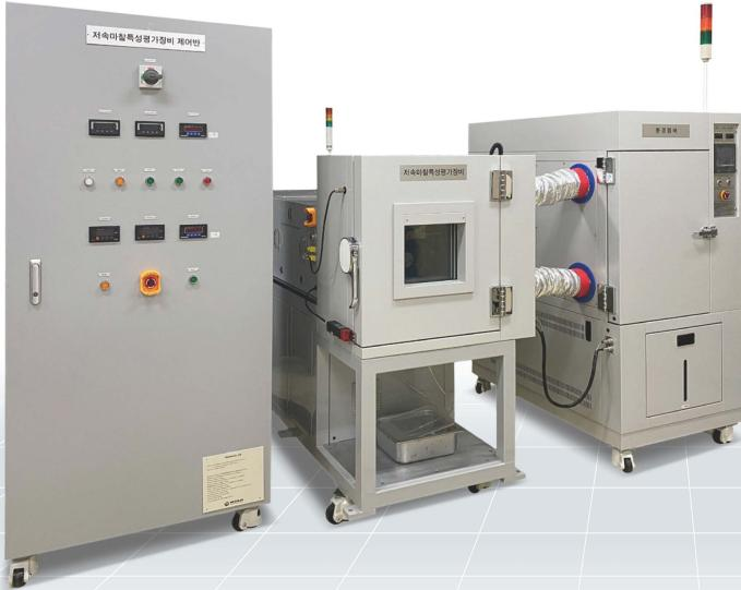
브레이크 패드 다이나모메터 (Model BDM220)는 저속과 고속 모터 구동에 의해 디스크 속도 조절이 가능하며, 디스크의 양방향으로 가해지는 압력에 의해 발생하는 디스크 시편과 브레이크 패드 시편의 마찰력을 실시간으로 표시 및 기록할 수 있도록 고안된 장비이다.
